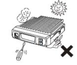
Не допускайте работу на передачу с максимальной выходной мощностью длительное время. Трансивер может перегреться.
